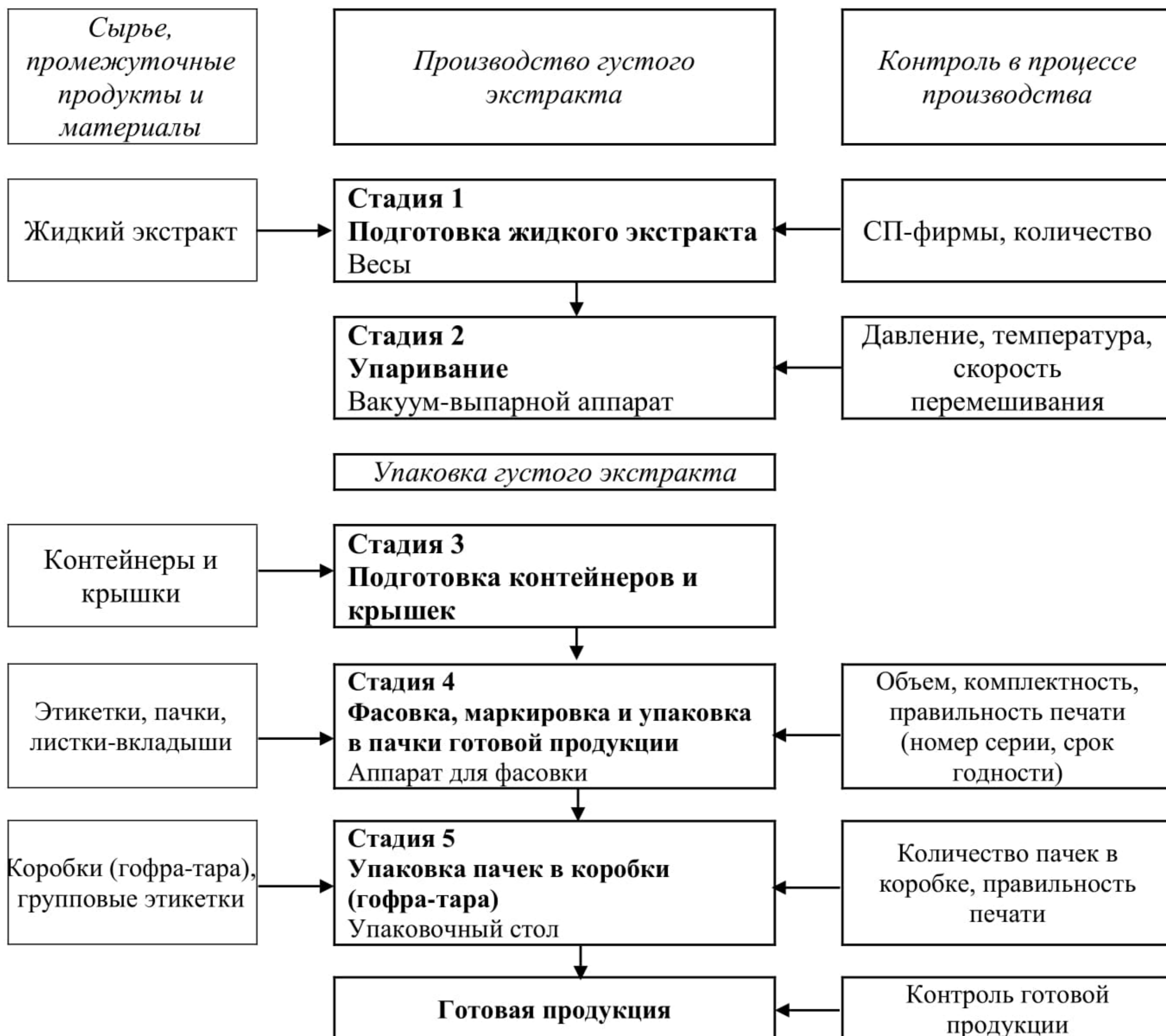
Рисунок 34 – Технологическая схема производства экстракта густого из жидкого
