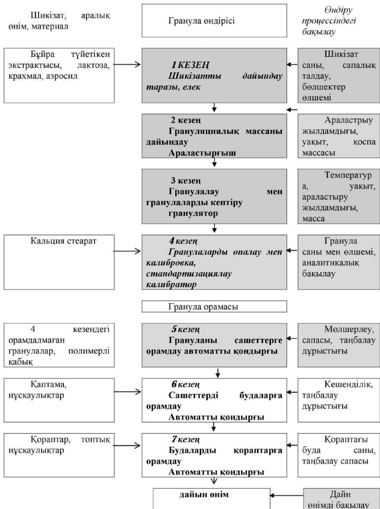
Сурет 4.4 - «Гепатогран» гранулаларын өндіру технологиялық процессінің схемасы
