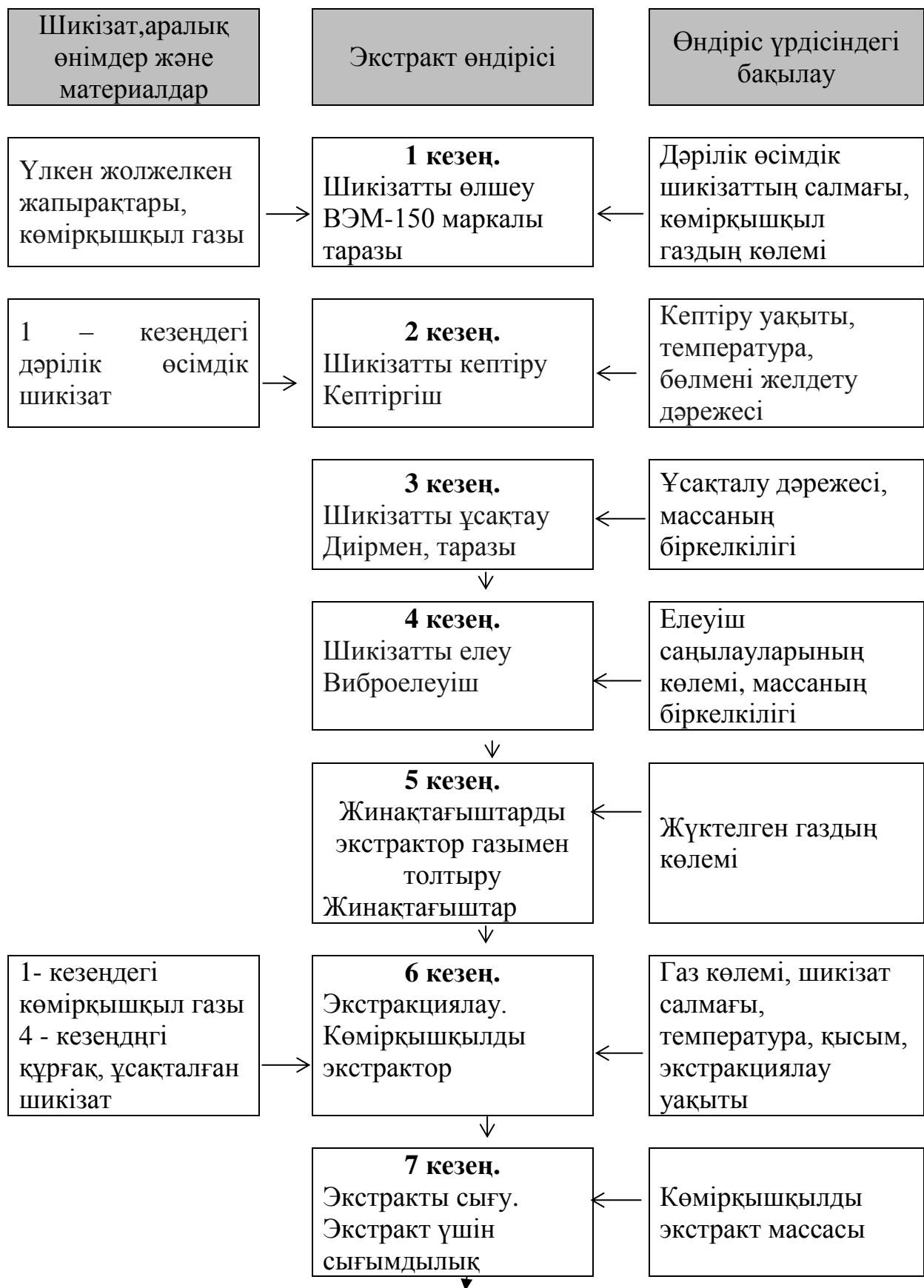
Сурет 5 – Үлкен жолжелкен жапырақтарының көмірқышқылды экстракт алудың технологиялық сызбасы, бет 1
