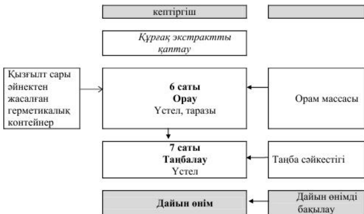
Сурет 19– Artemisia rupestris L. сабақтарынан құрғақ экстракт алу өндірісінің тәжірибелік - өндірістік технологиялық сызбасы
