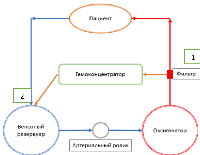
Рисунок 1 - Схема одновременной (классической) ультрафильтрации
