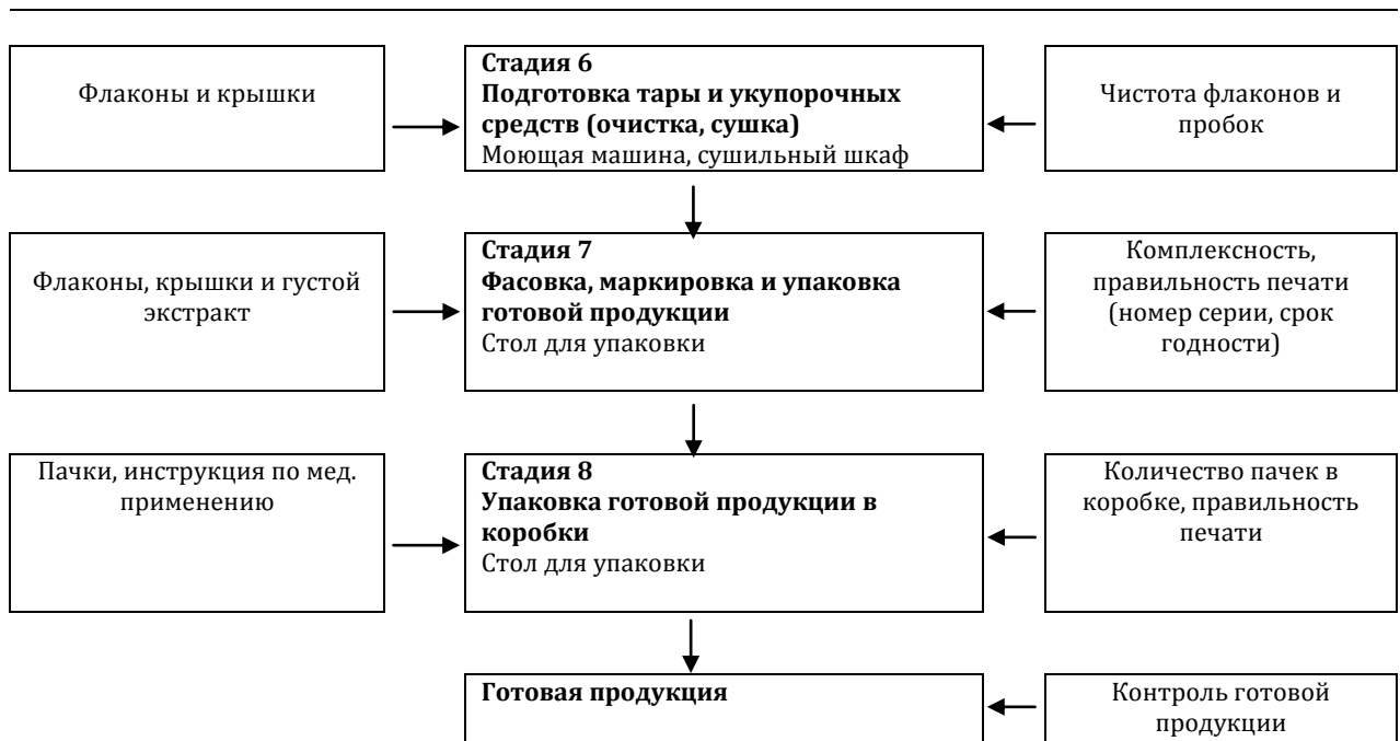
Рисунок 1 - Технологическая схема получения густого экстракта из корня Cichorium intybus L.
