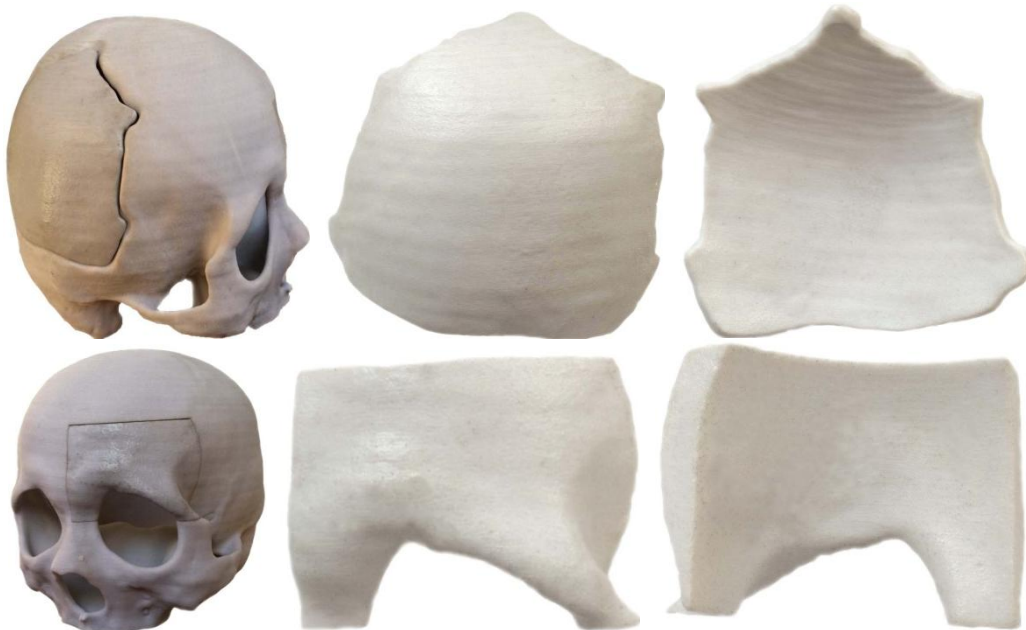
Рисунок 9 - Изготовление импланта из биоцемента на основе полиметилметакрилата
